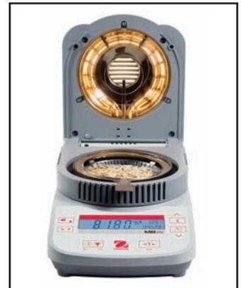
El OHAUS MB23 contiene un elemento de calentamiento infrarrojo, mientras que el MB25 usa tecnología halógena
