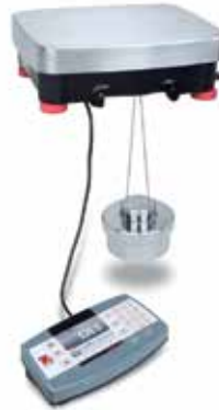
Uso del gancho para pesajes por debajo de la báscula
